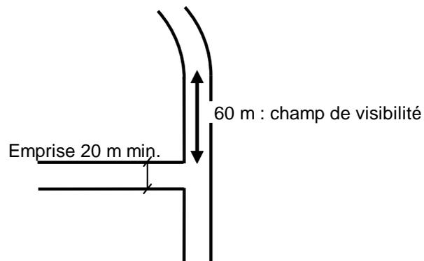
Toute intersection avec une voie de circulation dont l'emprise est inférieure à 20 mètres doit bénéficier d'un champ de visibilité minimal de 30 mètres avant le début d'une courbe dont le rayon de courbure est inférieur à 100 mètres.
