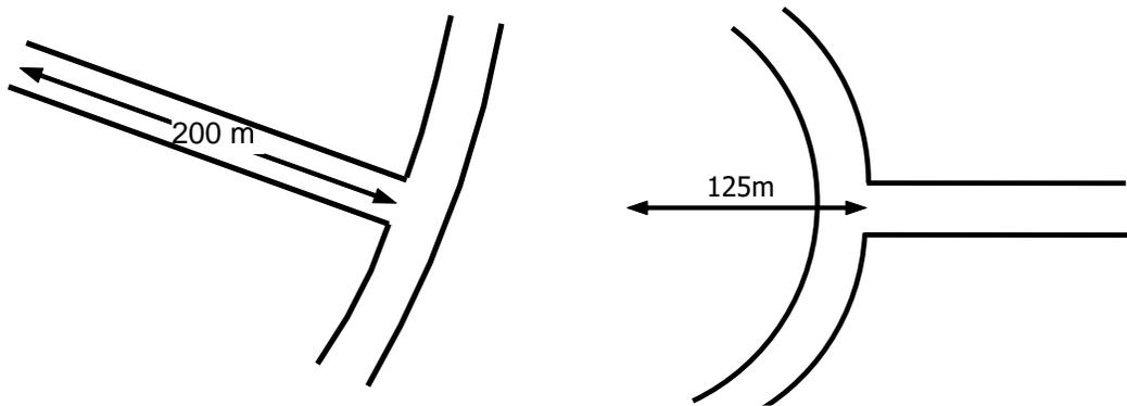
Toute intersection avec une voie de circulation de 20 mètres d'emprise ou plus doit bénéficier d'un champ de visibilité de 60 mètres avant le début d'une courbe dont le rayon de courbure est inférieur à 100 mètres.
